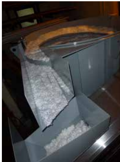
Dosiersystem MD400 mit Wiegebänder präzise Dosierung von Kunststofffasern. Dosiergenauigkeit: ±10 g
