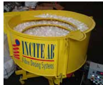
Dosieranlagen MD500 und SF1200SR in Finnland Dosierung von Makrokunststofffasern in Pucks und von Stahlfasern.
