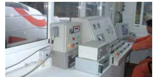
Dosiersystem MD400 mit Wiegebänder präzise Dosierung von Kunststofffasern. Dosiergenauigkeit: ±10 g
