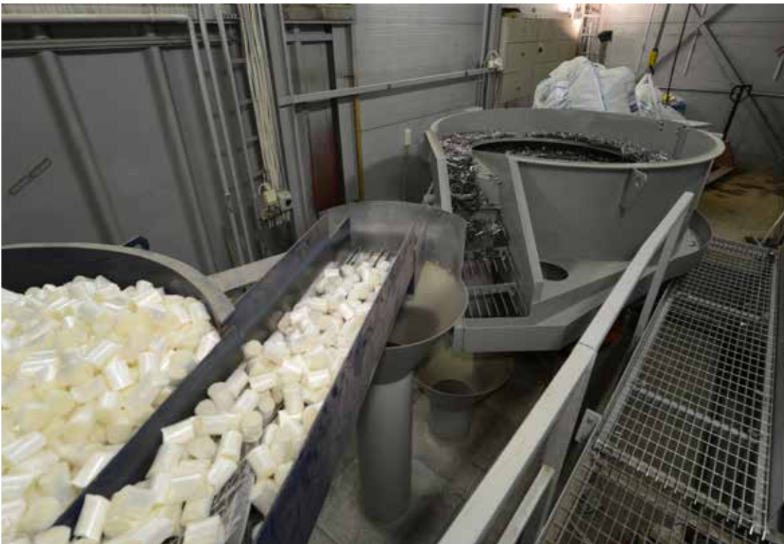
Dosieranlagen MD500 und SF1200SR in Finnland Dosierung von Makrokunststofffasern in Pucks und von Stahlfasern.
